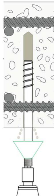
Würth Verbundankerschraube RELAST SE zur Durchstanzverstärkung
