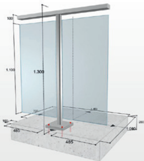
Geländer nach GEL 14 mit vordefinierter Ankerplatte und Dübeldurchmesser
