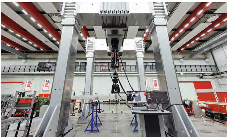
Versuchsaufbau im Reinhold Würth Innovationszentrum Curio, um das Produkt REINFORCE AC zu testen. Foto: Scanner GmbH
