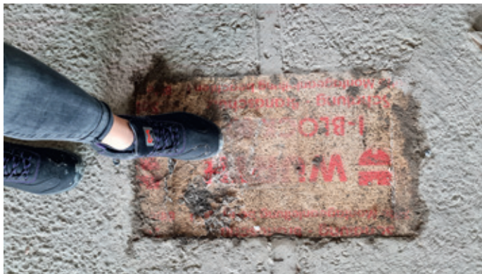
Trittsicherheit bis zu 800 kg auf 280 cm 2 (entspricht Schuhgröße 45)
