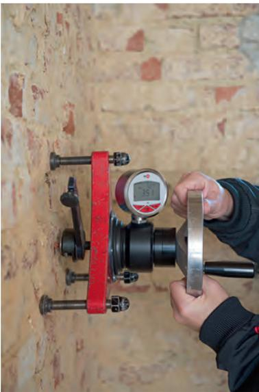
**Bild 1.** Dübel-Auszugsversuch für einen Kunststoffdübel mit einem mobilen Prüfgerät
