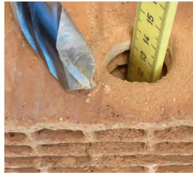
**Bild 27.** Probebohrung zur Ermittlung der Lochsteg-Geometrie in einem filigranen Hochlochziegel mit einem modernen Mehrzweckbohrer (Foto: Scheller)
