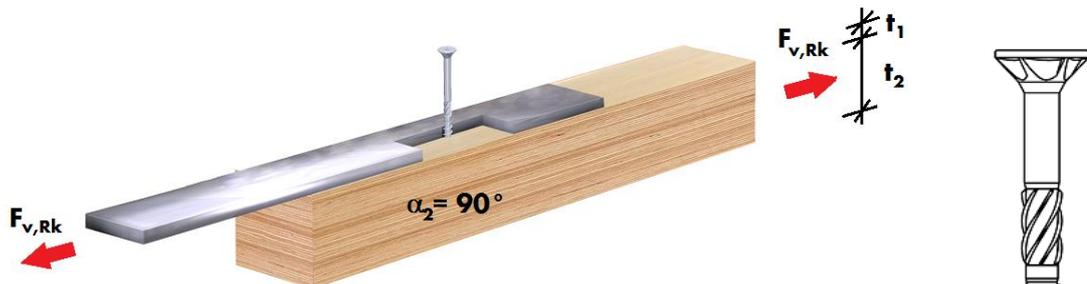
**ASSY 3.0 - Résistance au cisaillement  $F_{v,Rk}$  et  $F_{v,Rd}$  ( $k_{mod} = 0,8$ ) avec la longueur de vis minimale nécessaire  $l_{min}$**
