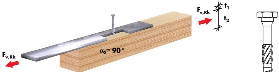
**ASSY 3.0 Kombi - Résistance au cisaillement  $F_{v,Rk}$  et  $F_{v,Rd}$  ( $k_{mod} = 0,8$ ) avec la longueur de vis minimale nécessaire  $l_{min}$**
