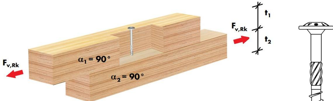
**ASSY 3.0 SK - Résistance au cisaillement  $F_{v,Rk}$  et  $F_{v,Rd}$  ( $k_{mod} = 0,8$ ) avec la longueur de vis minimale nécessaire  $l_{min}$**
