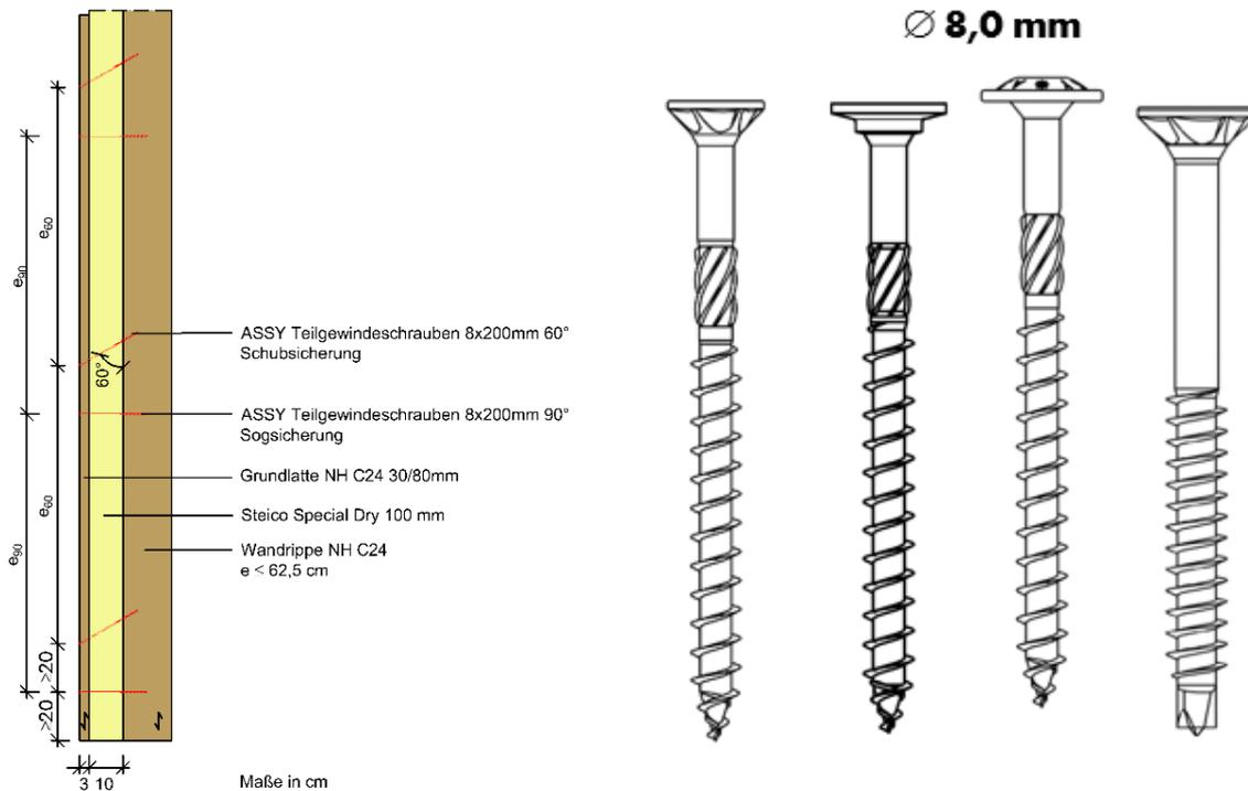
**Maximale Abstände  $e_{60}$  und  $e_{90}$  für die Befestigung einer druckfesten Steico Special Dry Fassadendämmung in cm**
