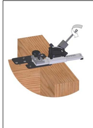
Drehung des Grundkörpers um 90°. Endverschraubung der im Hauptträger gesetzten ASSYplus VG 4 Schraube. Demontage des Grundkörpers und der Grundplatten.
