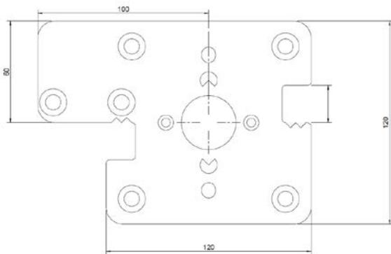
Einhängen des Nebenträgers in die Deckenkonstruktion (Spaltfreie Montage). Verschraubung der Grundplatten auf dem Hauptträger mit ASSY 4 CS Vollgewindeschrauben.
