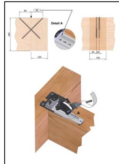
Drehung des VG Grundkörpers um 90°, Achtung Anhebung des Fixierknopfes! Verschraubung des ASSYplus VG 4 durch den Nebenträger in den Hauptträger. Die Schraubenlänge und Durchmesser ist entsprechend der Bemessung zu wählen.
