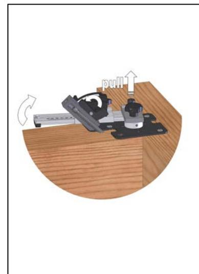
Lösen des Fixierknopfes und Drehung des Grundkörpers um 180°. Vollständige Versenkung der ASSYplus VG 4 Zylinderkopfschraube.
