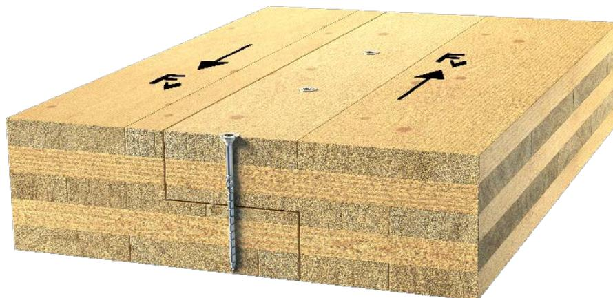
Le tableau suivant indique les distances minimales requises pour chaque fixation. La considération économique d'un assemblage doit prendre en compte tous les paramètres de celui-ci, à savoir : la résistance intrinsèque de la fixation et sa mise en œuvre (distance aux bords mini et entraxe mini).
