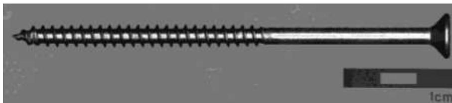
**Bild A25:** Geprüfte Schraube 6x120 ASSY 3.0, TG, Edelstahl
