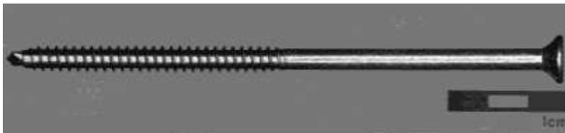
**Bild A27:** Geprüfte Schraube 6,5x140 ASSY plus, TG, Edelstahl
