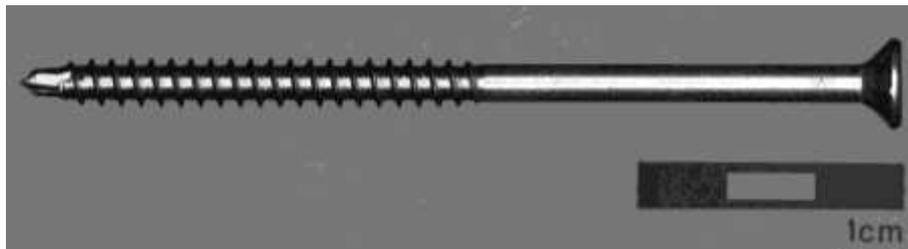
**Bild A23:** Geprüfte Schraube 5,5x100 ASSY plus 3.0, TG, Edelstahl
