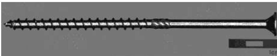
**Bild A5:** Geprüfte Schraube 7x160 ASSY 3.0, TG
