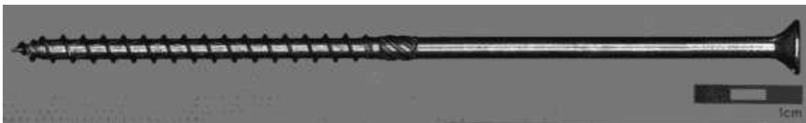
**Bild A7:** Geprüfte Schraube 8x220 ASSY 3.0, TG
