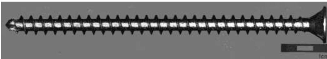
**Bild A19:** Geprüfte Schraube 12x200 ASSY plus, VG
