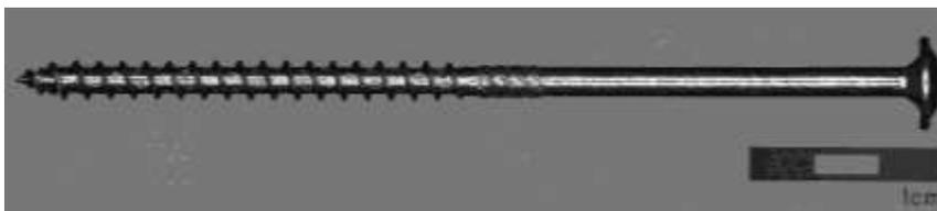
**Bild A3:** Geprüfte Schraube 6x140 ASSY 3.0, TG
