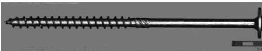
**Bild A11:** Geprüfte Schraube 12x240 ASSY 3.0, TG
