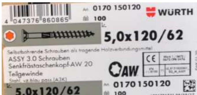
**Bild A2:** Geprüfte Schraube 5x120 ASSY 3.0, TG
