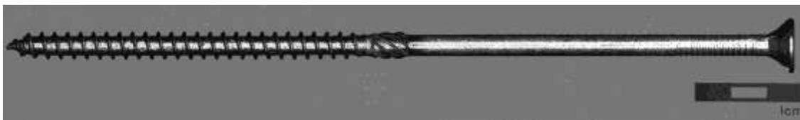
**Bild A29:** Geprüfte Schraube 8x220 ASSY 3.0, TG, Edelstahl
