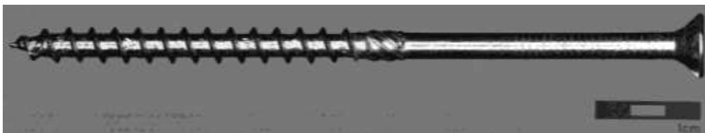
**Bild A9:** Geprüfte Schraube 10x200 ASSY 3.0, TG
