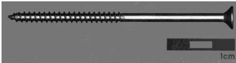
**Bild A21:** Geprüfte Schraube 5x100 ASSY 3.0, TG, Edelstahl
