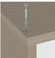
Die symmetrische Spitze ermöglicht ein schnelles, sicheres und punktgenaues Ansetzen.
