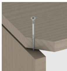
Trifft die Schraube auf die untere Platte, entsteht ein Spalt zwischen den beiden Bauteilen. Die obere Platte hebt sich von der unteren ab.
