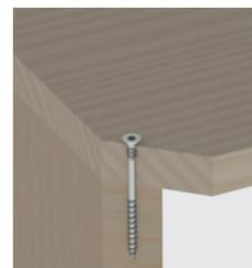
Das Unterkopfgewinde presst die Bauteile bereits während des Einschraubvorgangs zusammen.
