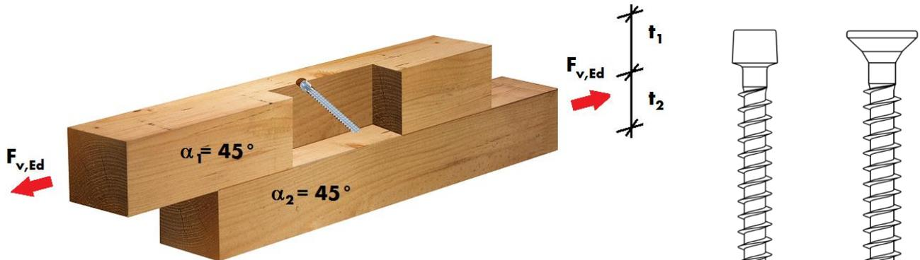
ASSY plus VG  $\varnothing$  6, 8, 10, 12mm - Zugschertragfähigkeit  $F_{v,Rk}$  und  $F_{v,Rd}$  ( $k_{mod} = 0,8$  und  $\gamma_M = 1,3$ ) mit erforderlicher Mindestdraubenslänge  $l_{min}$
