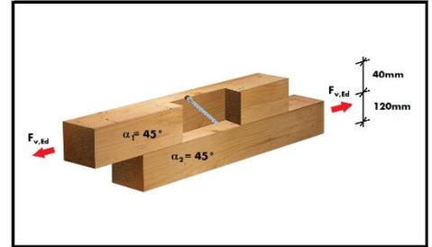
**ASSY plus VG - Zugschertragfähigkeit  $F_{v,Rd}$  und  $F_{v,Rk}$  ( $k_{mod} = 0,8$  und  $\gamma_M = 1,3$ ) mit erforderlicher Mindestschraubenlänge  $l_{min}$**
