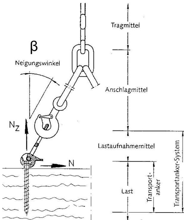
**Transportanker unter Schrägzugbeanspruchung**
