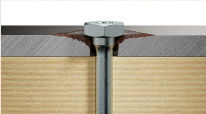
Indikator für Kontaktkorrosion sind Verfärbungen, wie z. B. Rotrost, im Kontaktbereich zwischen Schraube und befestigtem Anbauteil.
